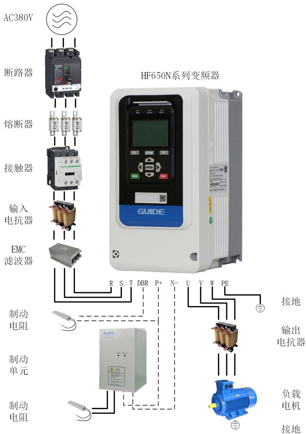
HF650N 变频系统外围电气元件的使用说明
