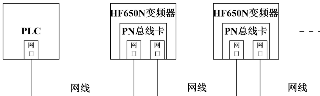
图 1 标准 PROFINET 电缆接线图
